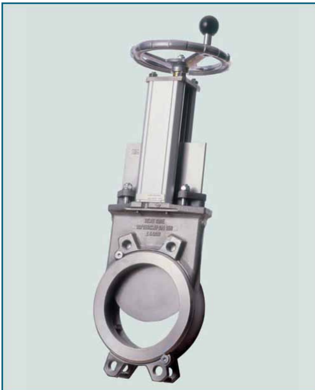
FIG – Válvula guilhotina uni-direcional para fluidos com sólidos em suspensão até 5%.
