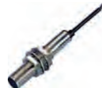
00311.001 Indicador elétrico de abertura com sensores de proximidade à dois fios (Namur) ou à três fios (PNP ou NPN) indicação aberta, fechada ou aberta/fechada
