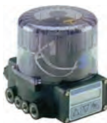
024.16.7 Posicionador eletro-pneumático 4-20 mA para válvulas acionadas pneumaticamente com atuadores de ação simples (NF - ar abre ou NA - ar fecha) ou de duplo acionamento. Tensão 24 V. Fornecida com o conjunto da válvula ou para montagem posterior. Posicionador com eletrônica micro processada para recebimento do sinal e versão opcional como controlador de processo com características de PID
