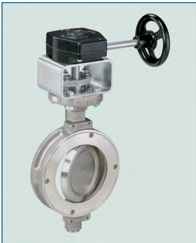
Válvula borboleta tipo wafer em construção duplo excêntrico. Vedação confiável mesmo em condições de extrema temperatura e pressão.
